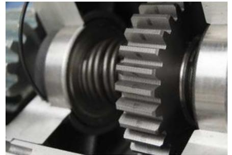
Motoréducteur avec **vis sans fin acier et couronne en bronze**, lubrifié par **graisse à faible viscosité** garantissant une longue durée de vie et un **taux d'usure réduit**.
